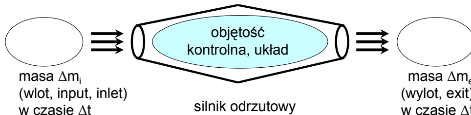
Rys. 15.3. Układ otwarty w ujęciu objętości kontrolnej.
